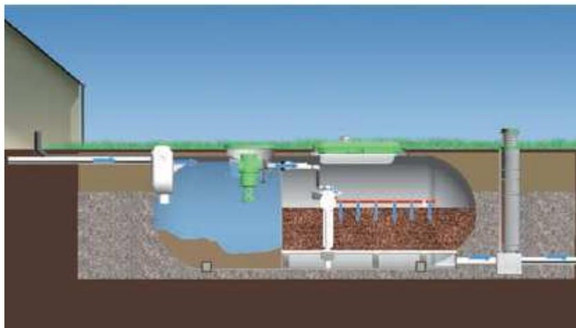
Schéma de principe d'une filière compacte (EpurFlo)
